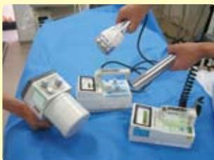
◀スクリーニング班が持参したサーベイメータ（携帯用放射線測定機）各種
