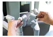
3D画像を見ながら手元のコントローラーを操作すると、離れたロボットアームに動きが伝わります
