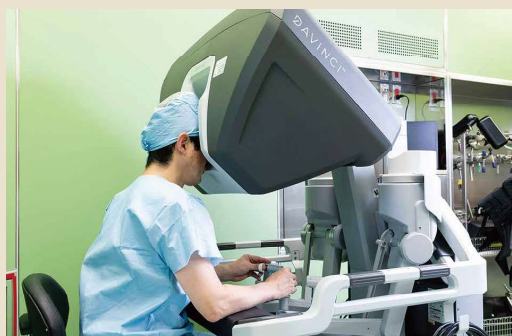
ロボット支援手術では、医師はロボットのアームについている鉗子やカメラを遠隔操作して手術を行います
